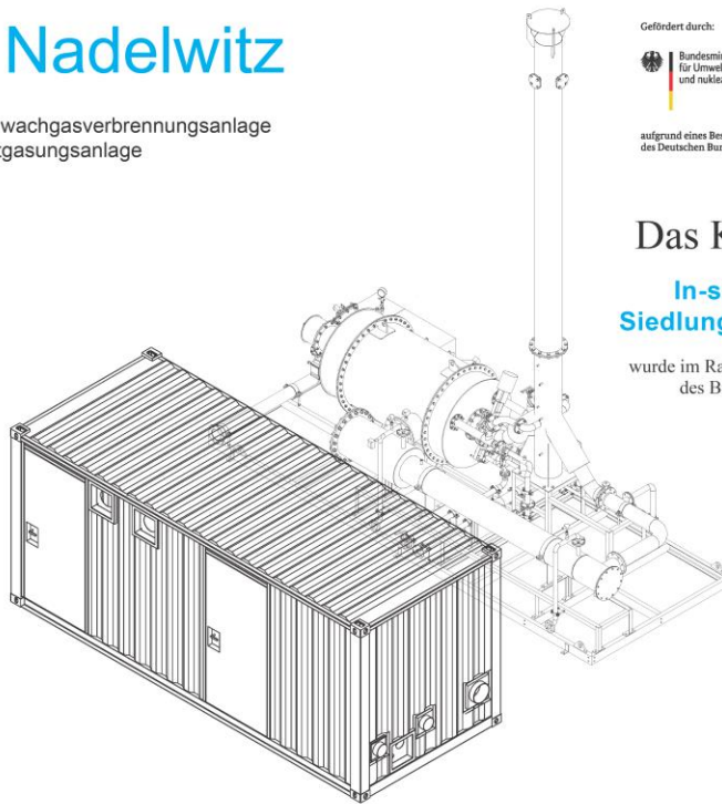
HTX Schwachgasverbrennungsanlage mit Wärmenutzung
